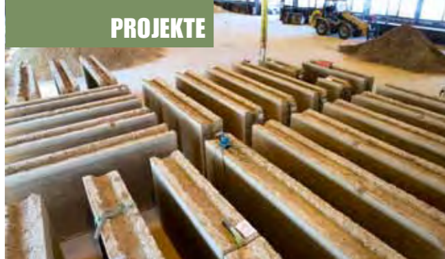
Der Lehm wird Schicht für Schicht in Schalungen gestampft.
