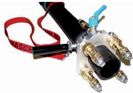
Der Terminator mit den vier Einsprühdüsen.
